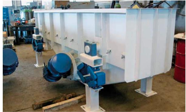
Suspensiones AB en alimentador de cemento
