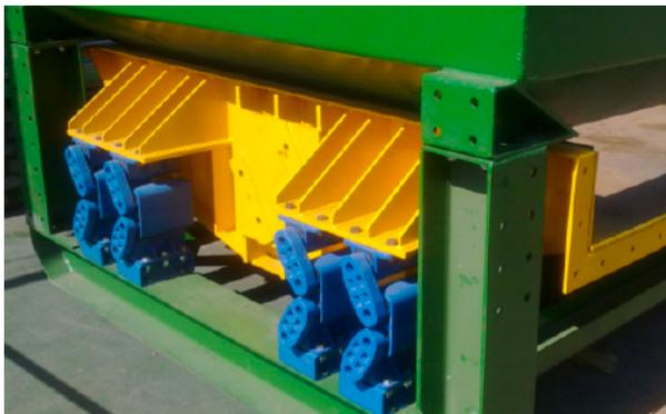
Suspensiones AB TWIN en criba inclinada para minerales
