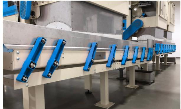
Transportador de dos masas equipado con brazos oscilantes dobles fabricados en fundición de aleación ligera
